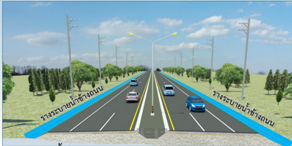
รางระบายน้ำข้างทาง - เกาะกลางแบบยก กม.19+500 ถึง กม.19+700
