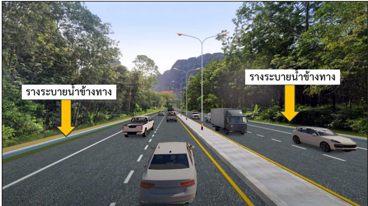
ช่วงที่ 2 กม.19+500 ถึง กม.19+700 รางระบายน้ำข้างทาง - เกาะกลางแบบยก
