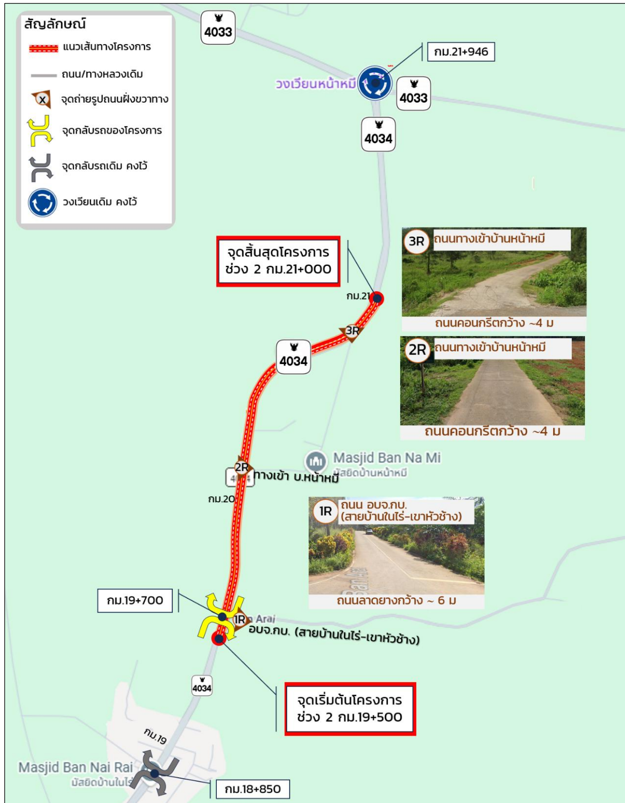
รูปที่ 5-8 ตำแหน่ง สภาพของถนนท้องถิ่น และตำแหน่งจุดกลับรถ บริเวณพื้นที่โครงการ ช่วงที่ 2 (กม.19+500 ถึง กม.21+000)
